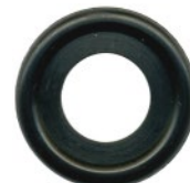
tórica NBR70 11x21x2,5 mm para tapón 0200.012.175 Cód. 0225.011.21
