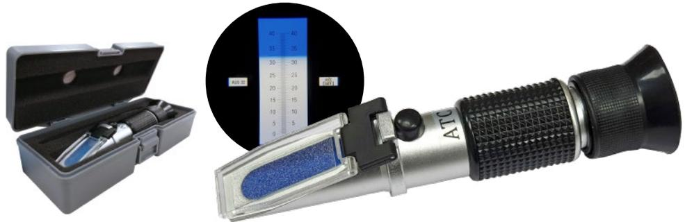
Previene muchos de los problemas en el circuito de AdBlue derivados del uso de un AdBlue de baja calidad, lo que da lugar a problemas en el inyector de AdBlue entre otros. La comprobación de la concentración del AdBlue es imprescindible cuando se está reparando o comprobando el circuito AdBlue (así lo indican muchos fabricantes de automóviles en sus protocolos de reparación cuando se esté trabajando en el circuito de AdBlue).
