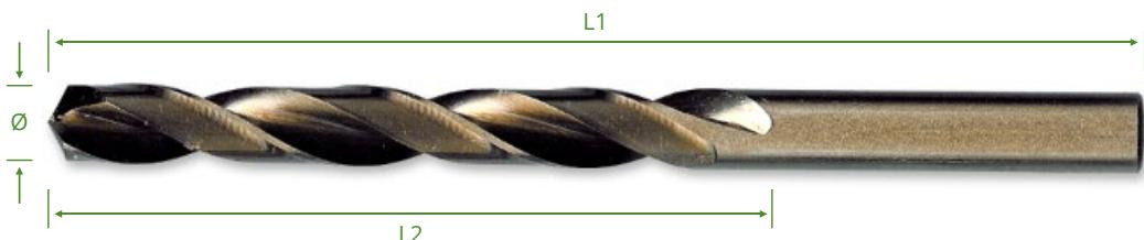
Ø: Diámetro de la broca L1: Largo total de la broca L2: Largo de corte (mecanizado)
