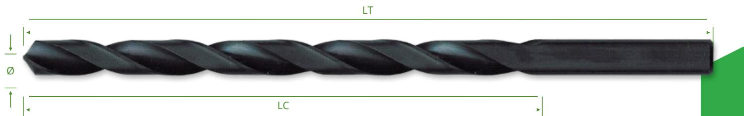
Ø: Diámetro de la broca   LT: Largo total de la broca   LC: Largo de corte (mecanizado)
