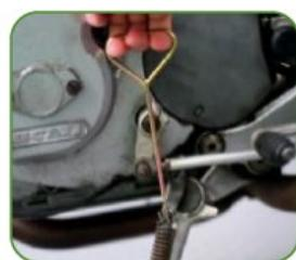
► ÚTIL EXTRACTOR / INSTALADOR DE MUELLES DE MOTO
